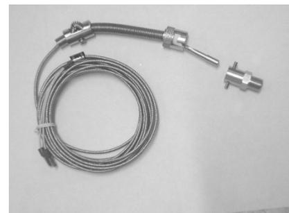
Gambar 7. Sensor suhu Thermokouple tipe-k.
