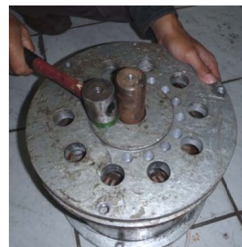
Gambar 13. Gaya mekanis tak langsung pada magnet permanen saat assembly .
